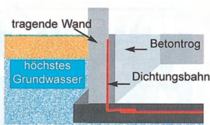
Technisch schwieriger und teurer ist es, eine solche Dichtung (nachträglich) auf den Innenseiten des Gebäudes anzubringen (Innendichtung). Hier wird ein zusätzlicher Innentrog erforderlich, um den auf die Dichtung wirkenden Wasserdruck statisch abzufangen. Eine Innendichtung gegen drückendes Wasser sollte daher nur in Einzelfällen bei nachträglicher Ertüchtigung von Altbauten zur Anwendung kommen.
