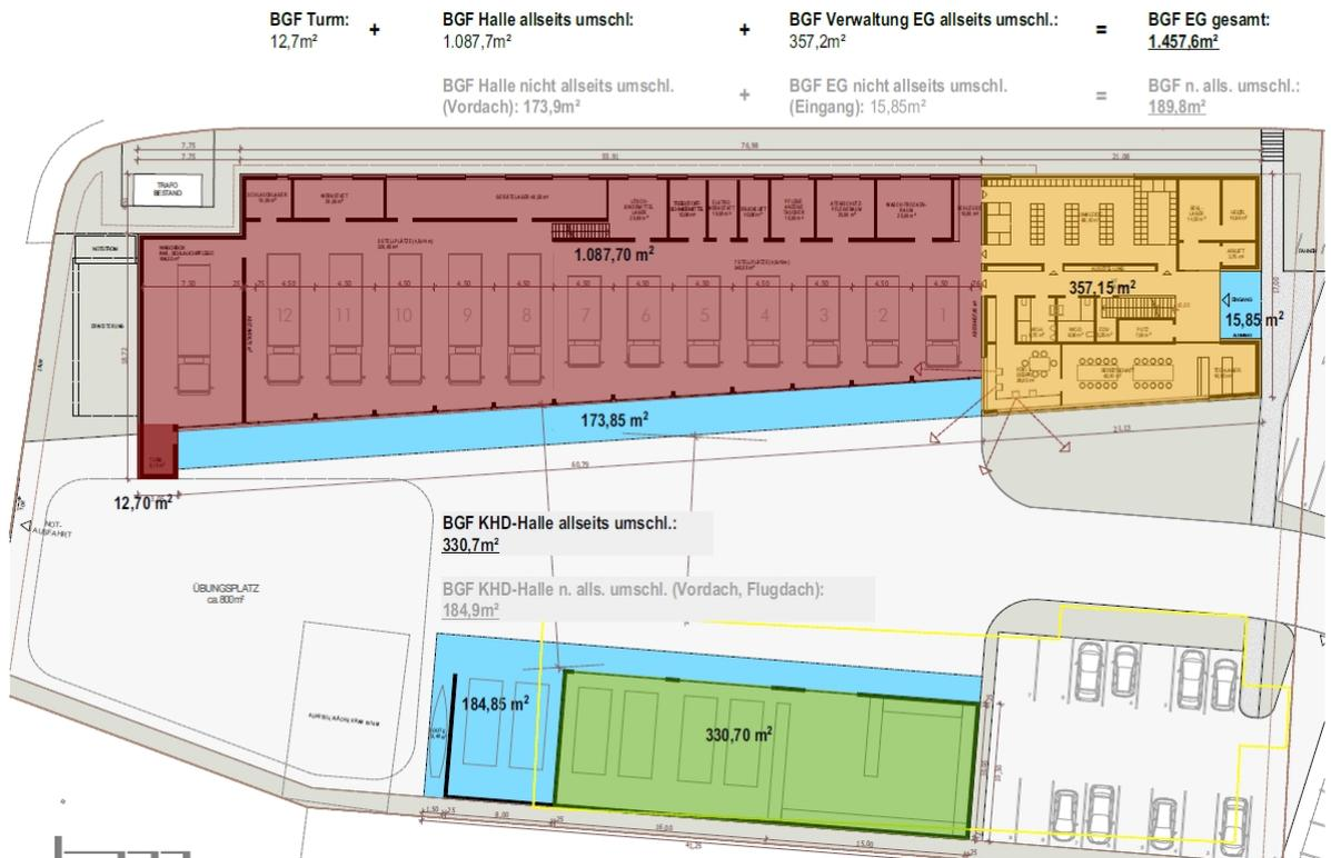
Abb. 7: Bebauungskonzept „Feuerwehr Enns“, Flächenausmaß und BGF, Hm Architekten ZT GmbH
