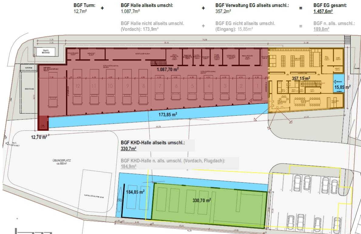
Abb. 37: Bebauungskonzept „Feuerwehr Enns“, Flächenausmaß und BGF, Hm Architekten ZT GmbH
