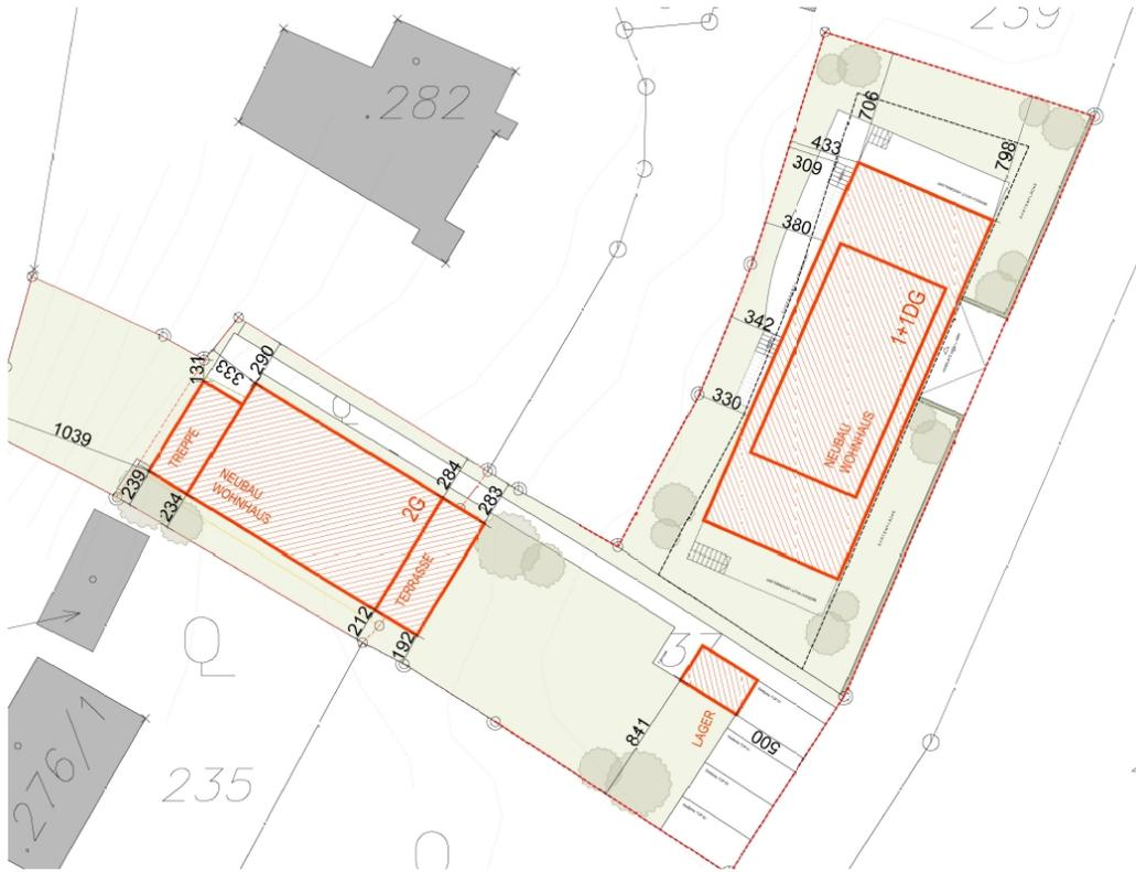
Abb. 5: Lageplan mit gekennzeichneten BV in Rot, DKM und Abstände zu den Nachbarparzellen, COMMOD HOUSE, 13.08.2021.
